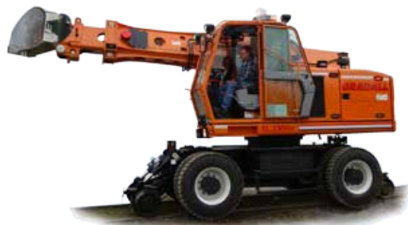
Gradall XL 3300RR on käytössä rautateidenvarsien siistimi- sessä ja kunnostustöissä, mutta sillä pystytään liikkumaan muillakin kovilla alustoilla.
