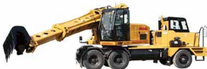
Gradall XL 5100 on kuorma-autoon istutettu kaivinkone. Sillä on helppo suorittaa pitkiä siirtoja työmaalta toiselle.
