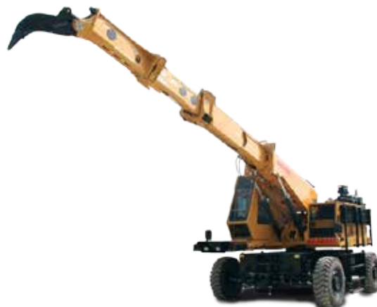
Gradall XL 7320 on kaivoksille suunnattu ruskaus- eli tur- vallisuustyömalli. Sillä poistetaan kalliopinnoista irtokivet, jotka voisivat tippua työntekijöiden päälle.
