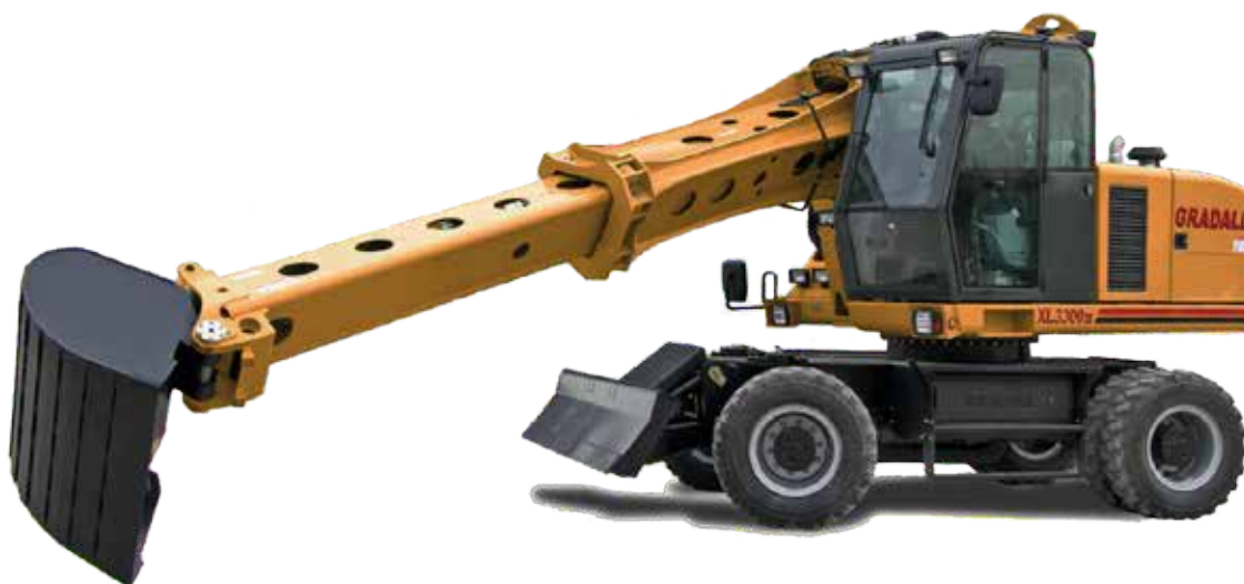
Gradall XL 3300 III on pyörälustainen malli, jolla työskennellään enimmäkseen kovilla alustoilla.
